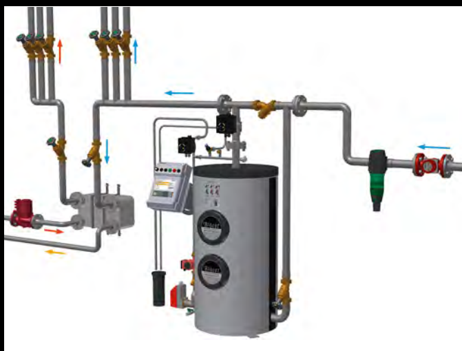
Schematische Darstellung einer Trinkwasser-Installation mit BIOCAT KS 14000
