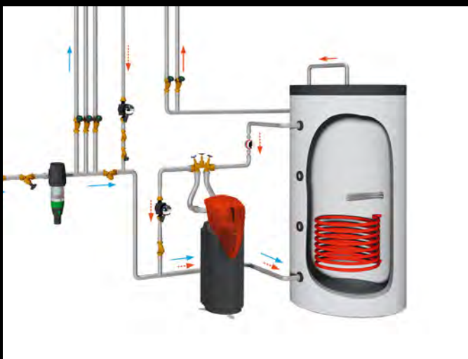
Schematische Darstellung einer Trinkwasser-Installation mit BIOCAT WS 6
