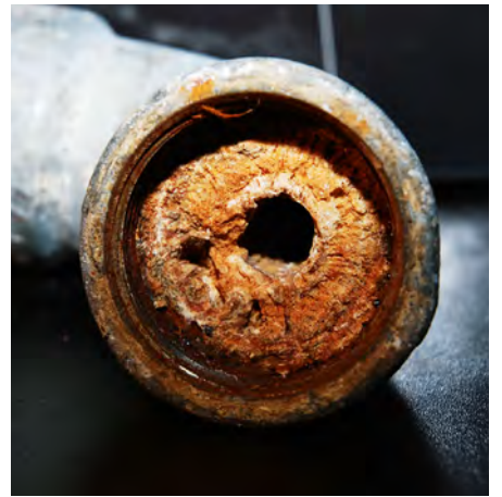
Kalkablagerung in Trinkwasserleitung
